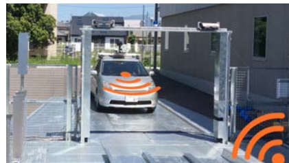
② 機械式駐車設備から駐車許可の信号を自動運転車へ送信
